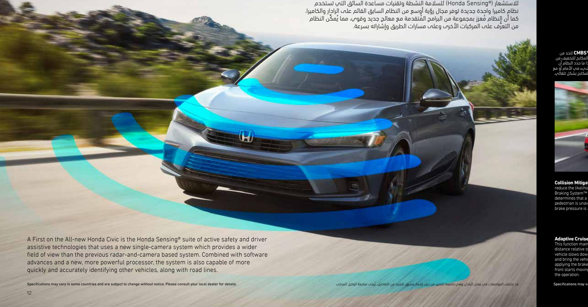
**نظام الحد من مغادرة الطريق (RDM):** يستخدم نظام الحد من مغادرة الطريق كاميرا مثبتة على الزجاج الأمامي لمعرفة ما إذا كانت السيارة تسرب في مسارها أم تغادر، حيث يقوم النظام بإجزاء التصحيحات المهمة لمحاضنة علىبقاء السيارة في مسارها، وهي بعض المواقف أحد المشاكل حيث يصدر النظام أصوات تحذيرية، وتعمل المكابح بشكل تلقائي.
