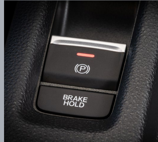
Frein de stationnement électrique (EPB) avec fonction Brake-Hold
