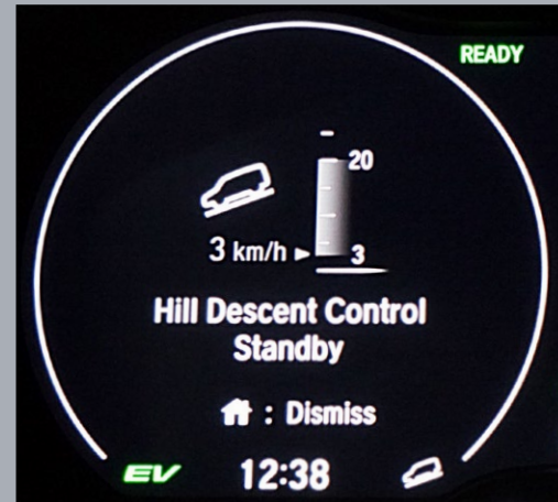
Contrôle de la descente de colline (HDC), qui régule automatiquement la vitesse entre 0 et 20 km/h lors de la descente des pentes.
