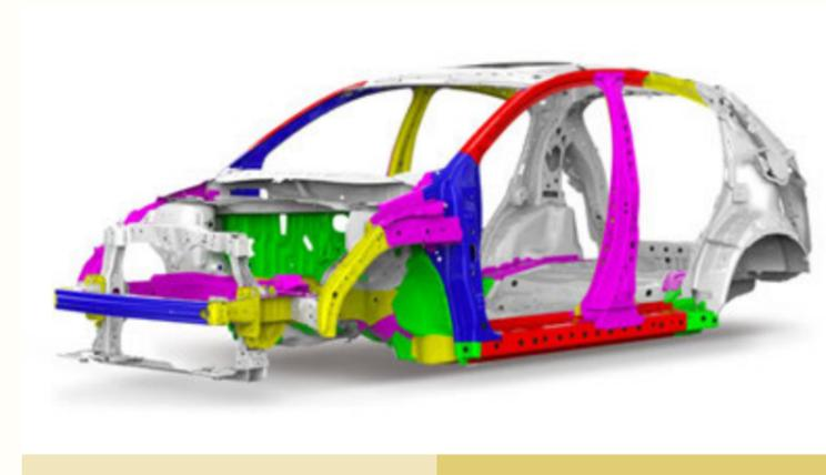
La structure de carrosserie à compatibilité avancée (ACE™) aide le conducteur et améliore la protection des occupants et la compatibilité en cas de collision frontale.
