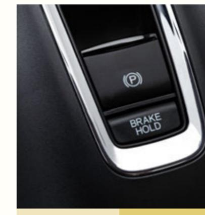
Gain de place et facilité d'utilisation, il suffit d'appuyer sur le bouton pour activer le frein de stationnement électronique, la fonction supplémentaire de maintien du frein, ce qui rend la conduite dans la circulation stop-and-go beaucoup plus pratique.
