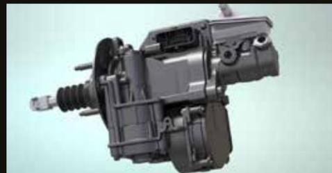
يحل معزز إلكتروني للفرامل (Electronic Brake Booster) محل فرامل السيرفو التقليدية، ويوفر استخداماً متماسكاً للفرامل مع قوة أعلى للتوقف في كل الأوقات.
