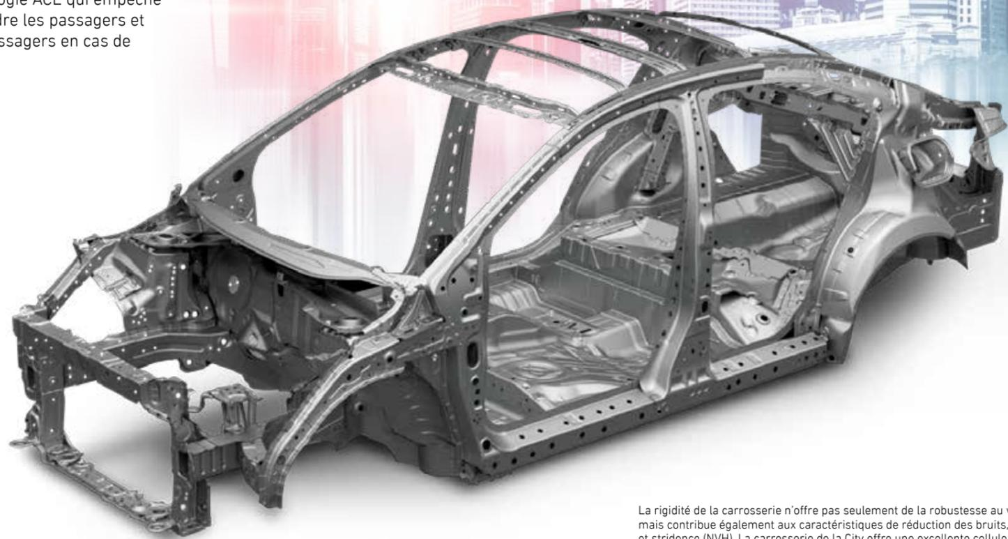
La rigidité de la carrosserie n'offre pas seulement de la robustesse au véhicule mais contribue également aux caractéristiques de réduction des bruits, vibrations et stridence (NVH). La carrosserie de la City offre une excellente cellule de sécurité et protection grâce à notre technologie de compatibilité avancée (ACE).
