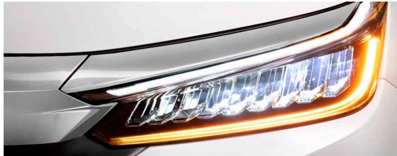
Phares entièrement à LED dotées d'un boîtier à LED à 9 faisceaux alignés, feux de circulation diurnes à LED incrustées et clignotants à LED en forme de L.
